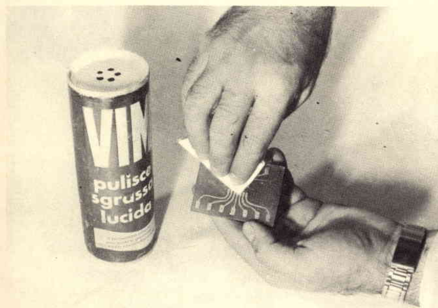
Fig. 12 - Per pulire il circuito stampato si può usare, in sostituzione dell'FD 1, anche il comunissimo VIM.
