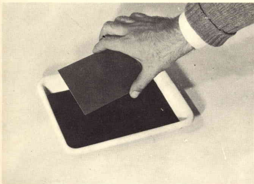
Fig. 8 - In questa bacinella, che deve essere in plastica od in vetro, viene versato il percloruro-ferrico per il trattamento di corrosione del rame non desiderato.
